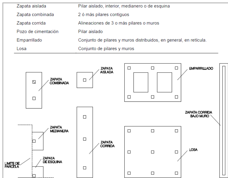
Figura 1: Breve explicación de los distintos tipos de cimentación superficial y esquema en planta de cada una. Obtenida de Ministerio de Fomento (2019a).
