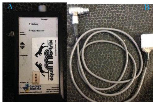
Figuran 3.1: El acelerómetro triaxial Equimetrix®. A: aparato de registro. B: sensor triaxial. Centaure Metrix.
