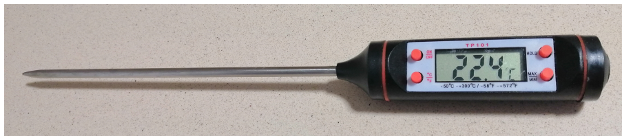
Figura 5.11: Termómetro de cocina basado en termopar. La punta de la varilla, que esconde el sensor propiamente dicho, se encuentra protegida por una vaina metálica conductora que se introduce en la sustancia cuya temperatura se desea conocer.
