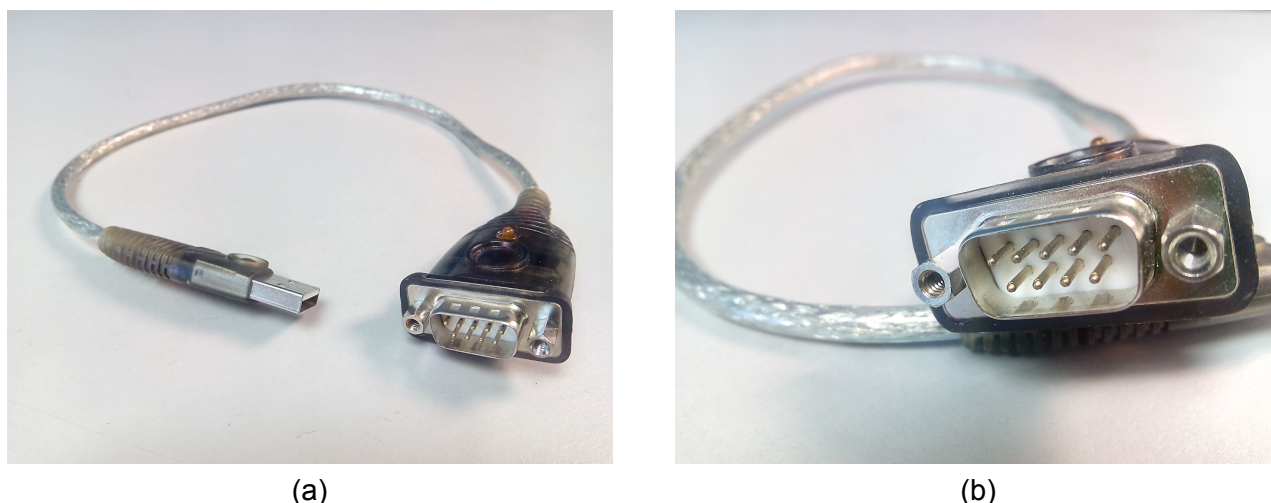
Figura 9.4: Adaptador de puerto USB a RS232 (a). Detalle del conector macho DB9 para RS232 (b). Los pines están numerados aunque, en la práctica, basta con usar los pines 2 y 3 (TX y RX).
