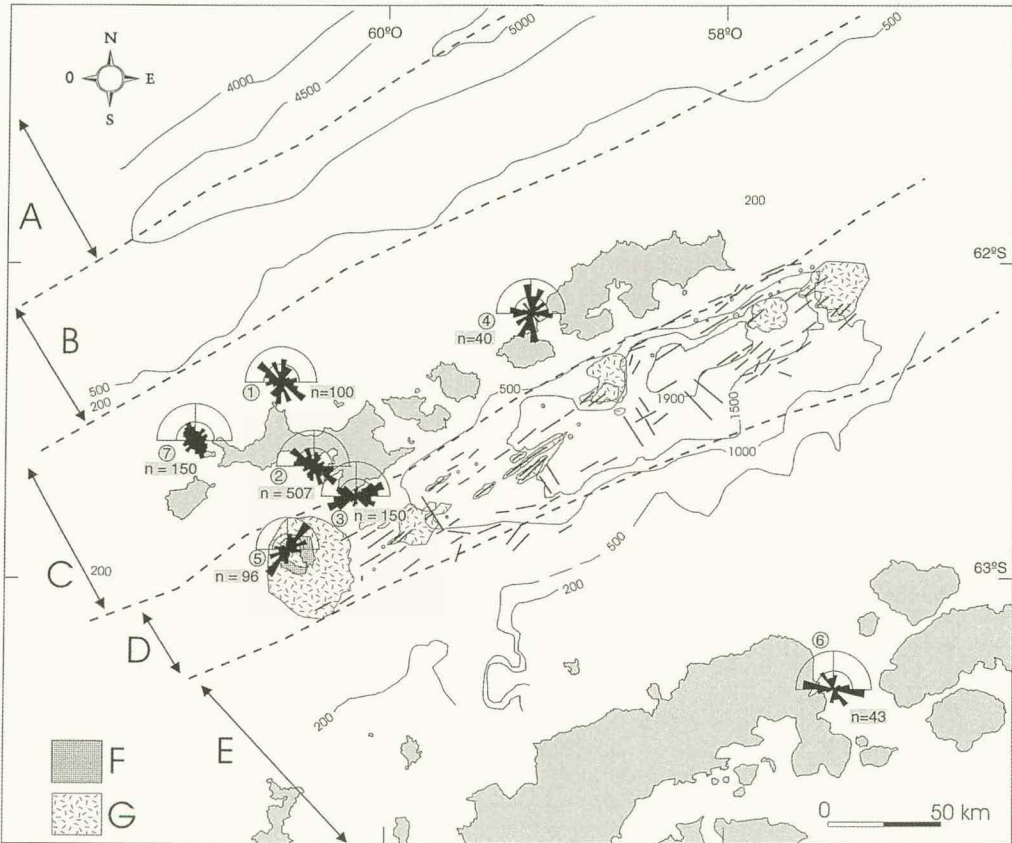
Fig. 2.—Esquema morfoestructural de la región de la Cuenca de Bransfield (basado en GRÀCIA et al. , 1996). (A) Antigua Placa Phoenix. (B) Prisma de acreción. (C) Arco magmático y corteza continental de las Shetland del Sur. (D) Cuenca de Bransfield. (E) Placa Antártica. (F) Edificios volcánicos subaéreos. (G) Edificios volcánicos submarinos. Sobre los puntos de medida se han representado las orientaciones de todas las fallas observadas (máximo valor de las rosas, 20%). Líneas continuas gruesas = fallas. Líneas continuas finas = profundidad en metros. Número de las estaciones como en la Fig. 1.
