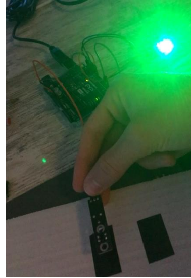
Ilustración 6, sensor de línea detectando una línea
