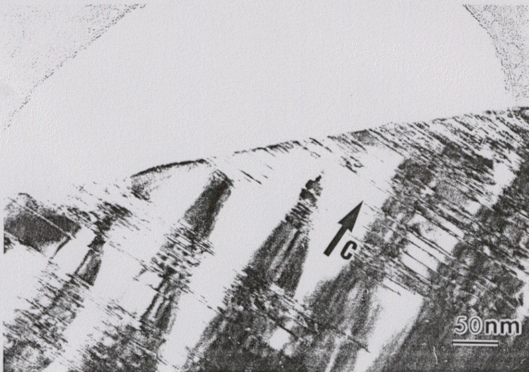
Figura III.2.12.- Micrografía mostrando defectos extensos perpendiculares al eje c ,. Se observa el contraste interferencial debido a defectos tipo paredes de macla, fronteras de antifase, etc.
