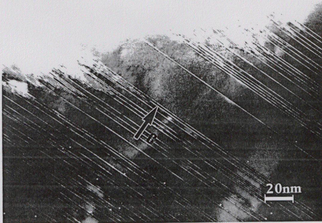
Fig. III.2.13.- Micrografía electrónica a 550.000 aumentos, eje de zona [-1\ 1\ 0] donde se observa como los defectos presentan longitudes variables, y en consecuencia el mayor número de ellos se encuentra en la superficie del cristal.
