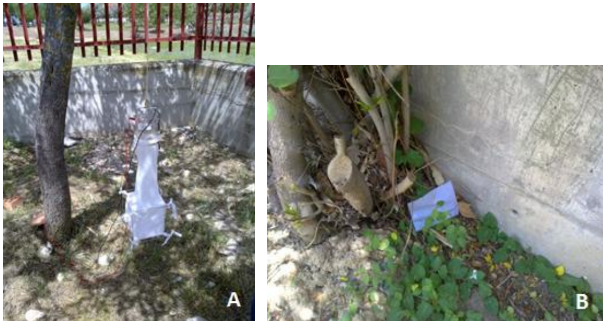
Figura 6. A) Trampa de luz (CDC); B) Trampa adhesiva (Fuente: Laboratorio de Entomología Médica ISCIII).
