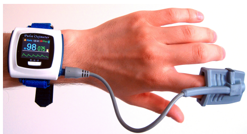
Figura 1.8 Sensor de oximetría y fotopletismografía (PPG). [Figura]. Recuperado de https://commons.wikimedia.org/wiki/File:Wrist-oximeter.jpg .
