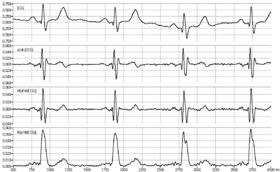
Figura 2.17 De arriba a abajo, las cuatro gráficas representan: la señal de ECG, la primera derivada del ECG, la transformada de Hilbert de la primera derivada del ECG y la envolvente de la primera derivada del ECG [15].
