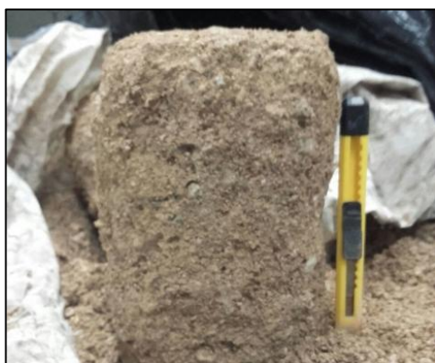
Figura 16 Muestra de arena limosa inalterada extraída de sector Curvas de la Leona y su curva granulométrica. (Carballo et al., 2018)
