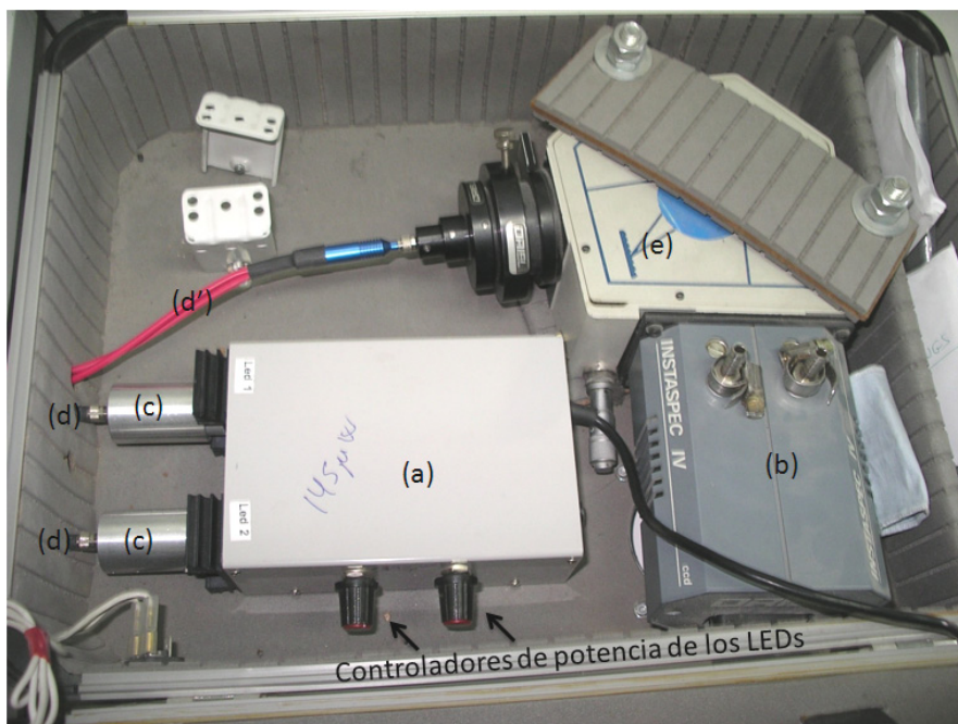
Figura 18. Fotografía del módulo portátil de excitación de los cabezales del biosensor y de monitorización de la fluorescencia de las microalgas inmovilizadas en los mismos. (a) unidad de iluminación dual LED con control independiente de la potencia radiante de cada uno; (b) detector CCD; (c) colimador de luz provisto de conectores SMA905 para fibra óptica multimodo; (d)-(d'), extremos proximales del cable de fibra óptica trifurcada; (e) espectrógrafo con red de difracción de 600 líneas/mm.
