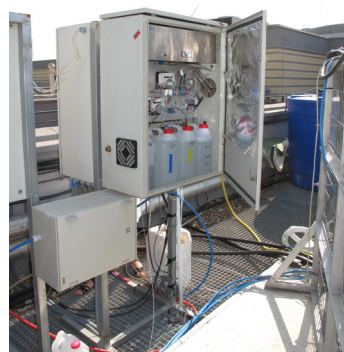
Figura 65. Biorreactor de bolsas introducidas en una estructura metálica con forma de ortoedro (izq.) y dispositivo sensor completo (dcha.), ambos instalados en la azotea del Centro de Investigaciones Científicas de la Isla de la Cartuja (Sevilla).
