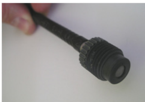
Figura 63. Terminal sensible luminiscente montado en el extremo distal de la fibra óptica bifurcada que conduce la luz desde/a el equipo Optosen®.
