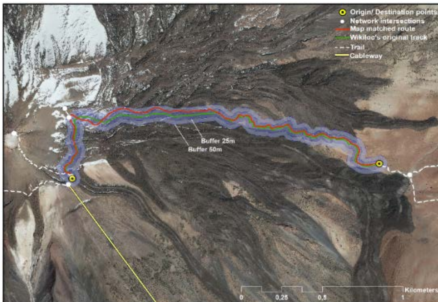
Figura 76. Ejemplo ilustrativo del proceso de map matching o ajuste de rutas
