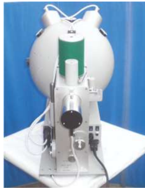
Figura 13. Adaptómetro Goldman-Weekers. Fuente: Narayan, 2021.
