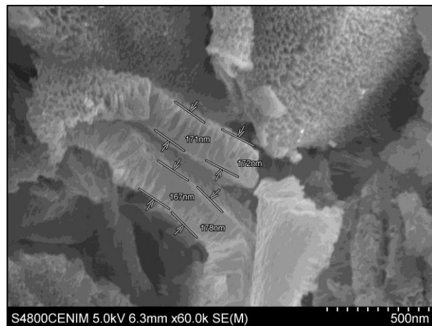
Figura 76. Imagen SEM ejemplo de la medición de la capa anódica de una muestra con tratamiento D+CAA, a x60000 aumentos.
