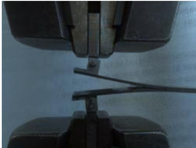
Figura 32. Detalle de la muestra DCB en el equipo de ensayo mecánico.
