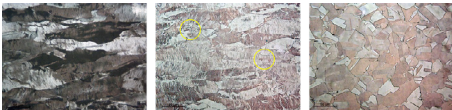
Figura 24. Evolución microestructural del cobre durante el proceso de recristalización. Fuente: elaboración propia.
