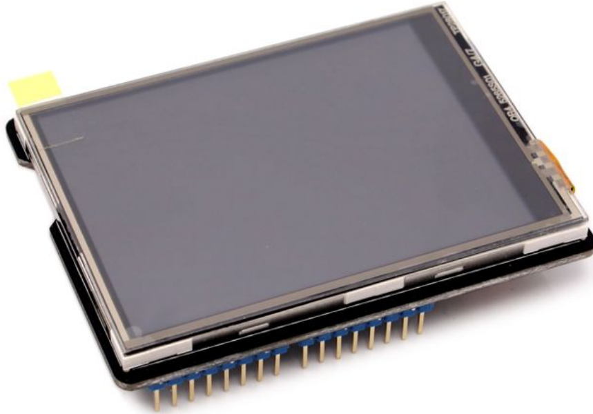
Figura 7: Pantalla Seeed TFT de 2.8 pulgadas
