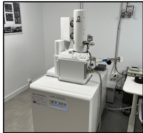
Fig 4: Fotografía tomada en el CNME del microscopio electrónico de barrido con el equipo de catodoluminiscencia integrado.
