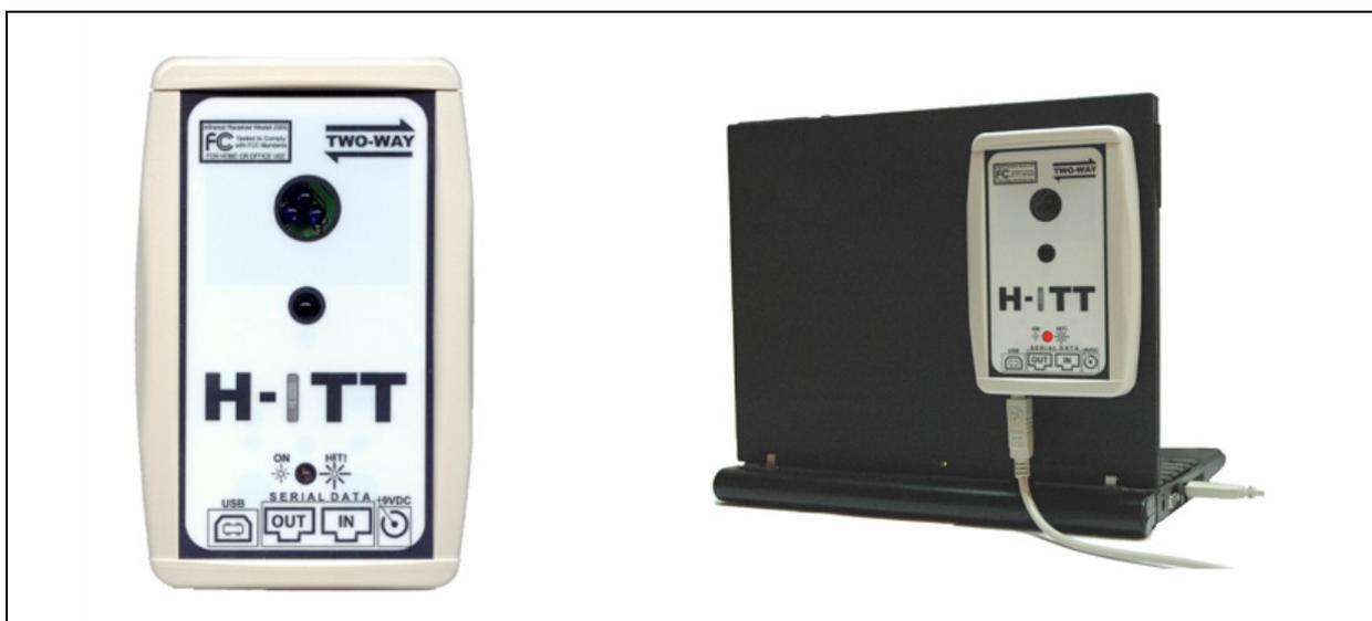
**Fig. 8: La unidad receptora de infrarrojos del sistema de H-ITT**
