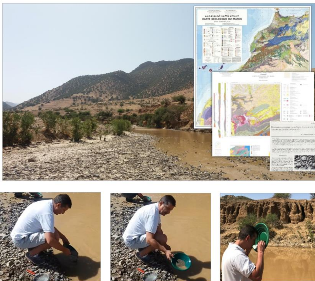
Figura 6: Exploración minera de monacita gris: el geólogo Enrique Burkhalter bateando una muestra de sedimento
