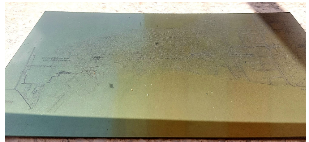
Fig.34. Endurecimiento de la plancha al sol. Se puede apreciar el cambio de tono en la plancha.
