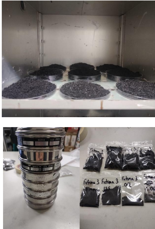
Figura 3. Análisis granulométrico. Piroclastos dentro de estufa de secado (a). Torre de tamiz (b). Piroclastos clasificados por granulometría (c)
