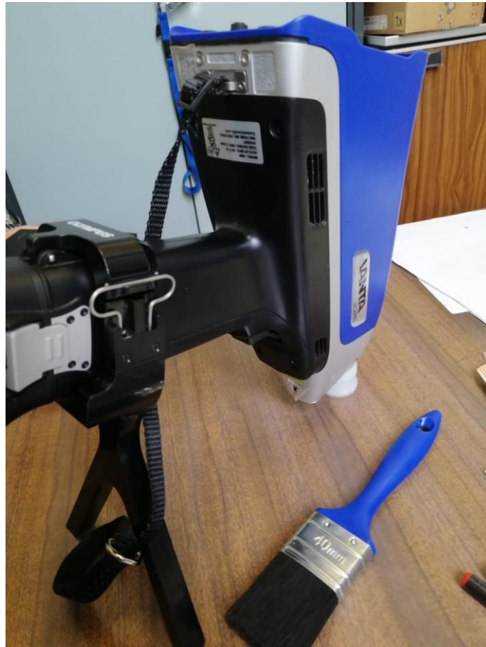
Figura 4. Olympus Vanta M Series XRF Analyser utilizado para la realización de las mediciones elementales y probeta plástica donde se prepararon las muestras.
