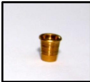
Figura 22a. Interfase de conexión de la mesoestructura de Co-Cr al recubrimiento acrílico.
