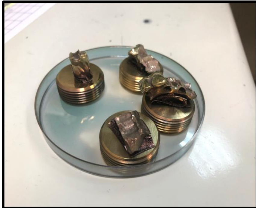
Figura 37. Muestras orificadas listas para su análisis con MEB.
