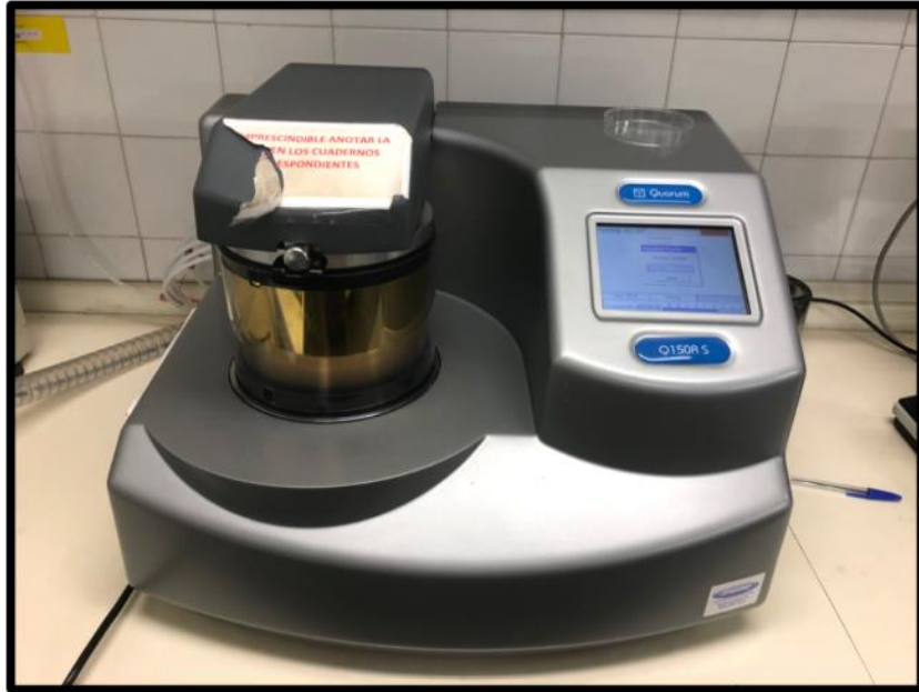
Figura 36. Máquina metalizadora Quorum 150R S ® para el sputtering de las muestras.
