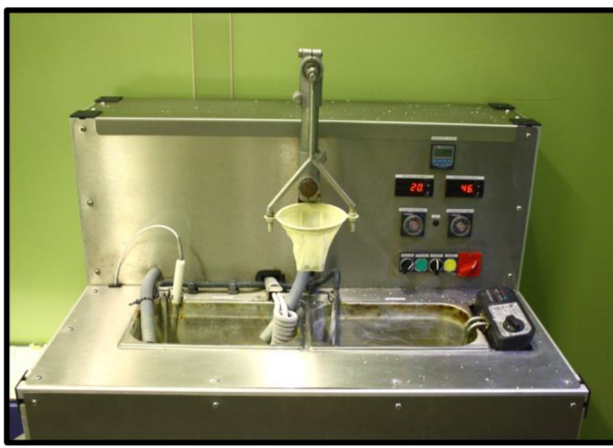
Figura 26. Máquina de termociclado empleada para el envejecimiento de las probetas.
