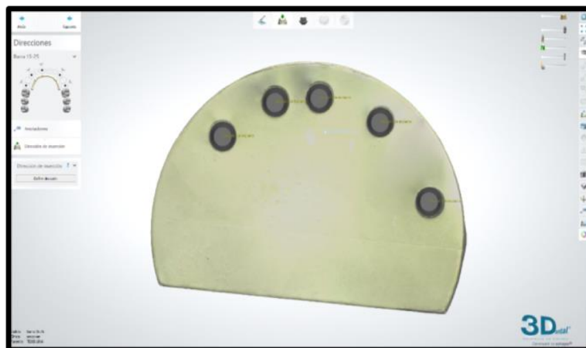
Figura 10. Eje de inserción de la prótesis visto desde el plano horizontal superior.
