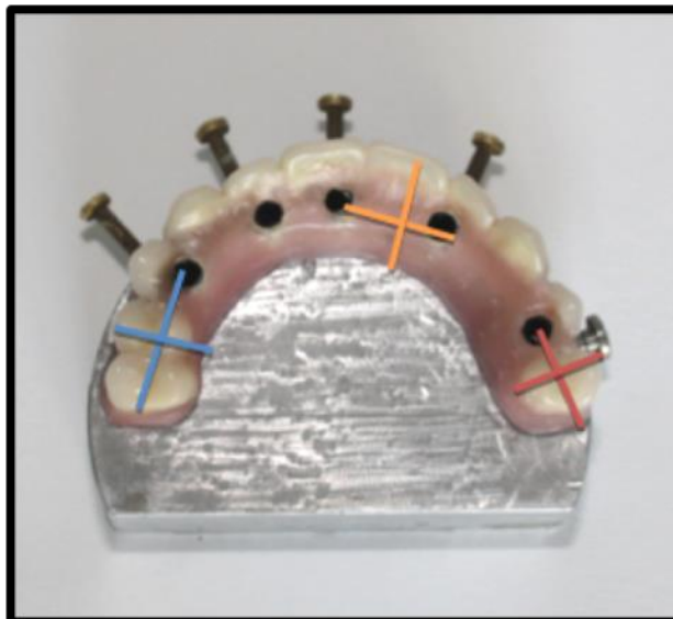
Figura 27. Puntos para el ensayo de flexión en las prótesis. Azul: cd . Rojo: ci . Naranja: sa .
