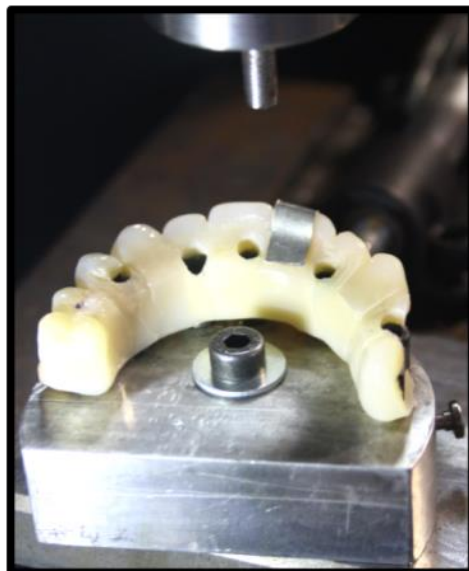
Figura 32. Lámina de Sn para el ensayo de flexión en ci con punzón redondeado ( vista oclusal ).
