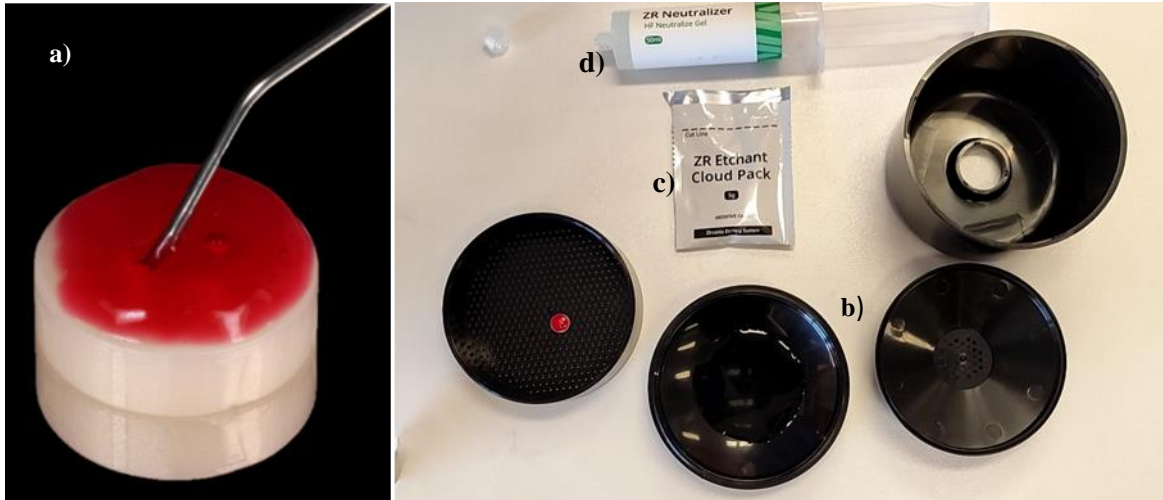
Fig. 3. Tratamiento de superficie mediante grabado ácido en caliente: a) Aplicación de AF al 9% sobre la superficie de la muestra; b) Contenedor de triple cierre; c) Paquete generador de calor; d) Agente neutralizador de AF
