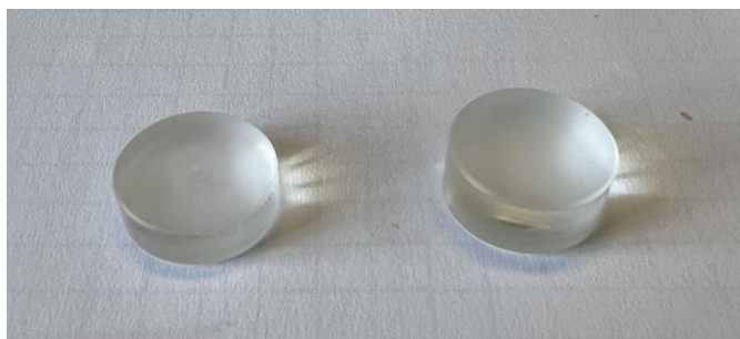
Fig. 2 Preparación del par de cilindros de PMMA.
