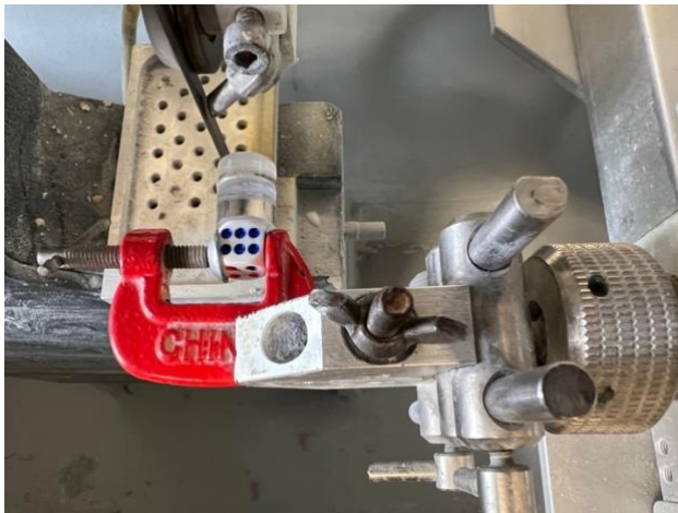
Fig. 6 Montaje de la muestra a máquina seccionadora de bandas.
