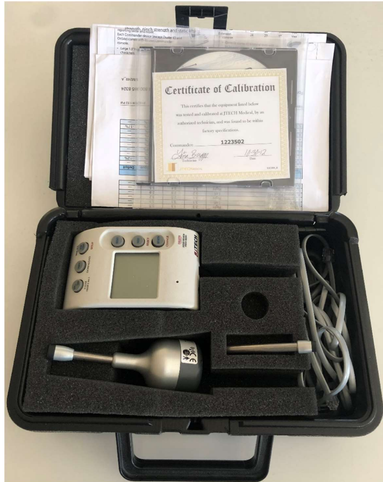
Figura 12. Dispositivo para medir el umbral de dolor a la presión: Algómetro Commander del fabricante Jtech Medical.
