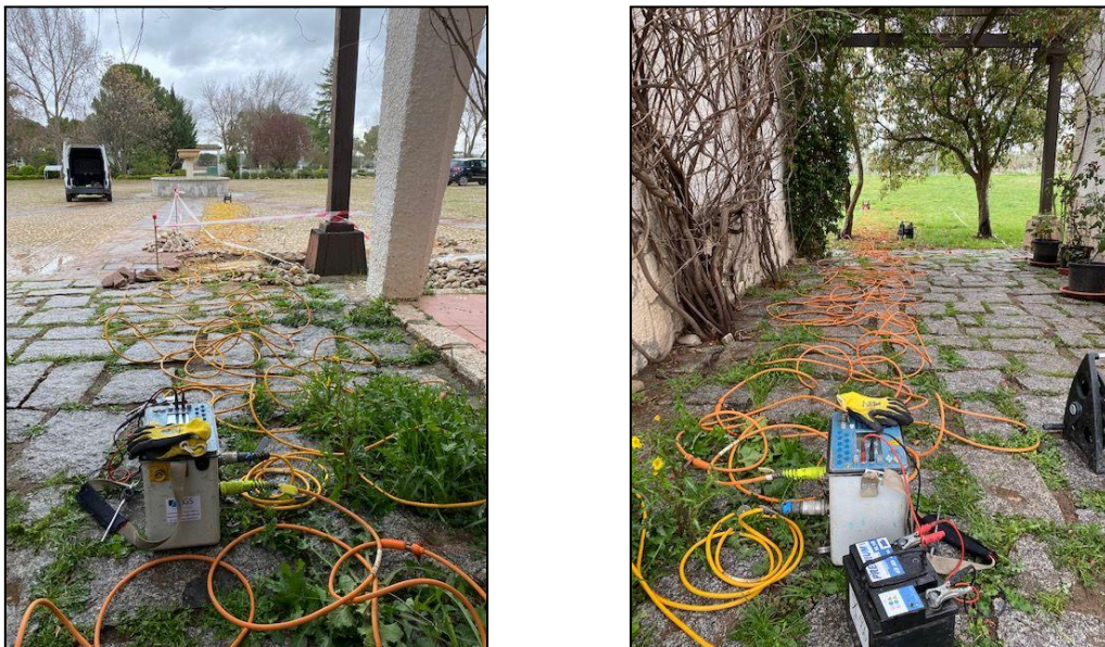
Fig. 11: La imagen de la izquierda corresponde al inicio del perfil 1 y la de la derecha, al final del mismo. Además, pueden observarse cuatro rollos, correspondientes a los cuatro cables que componen el perfil.
