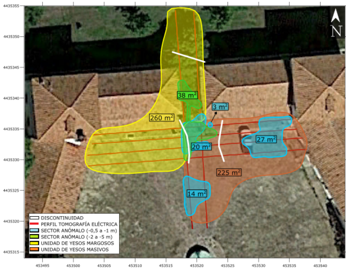
Fig. 18: Imagen satélite en la que se observa la disposición en planta de los materiales más vulnerables a experimentar procesos de disolución; así como la extensión en superficie, que presentan.
