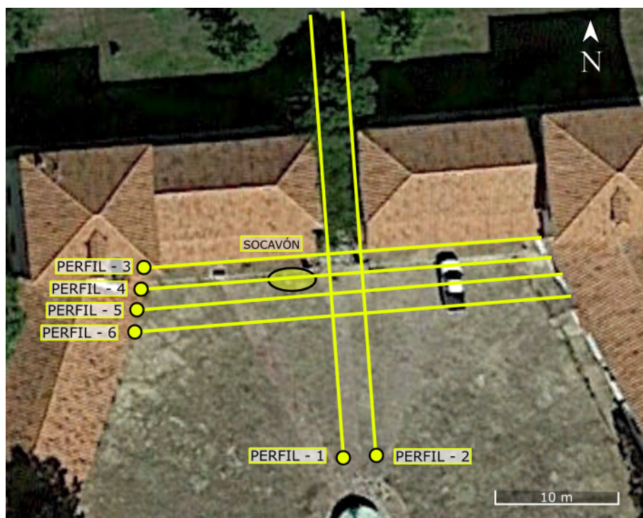
Fig. 8: Imagen satélite de la zona de estudio en la que se observan los perfiles de tomografía eléctrica realizados y sus inicios señalizados con un círculo amarillo; así como la localización del socavón observado en superficie.
