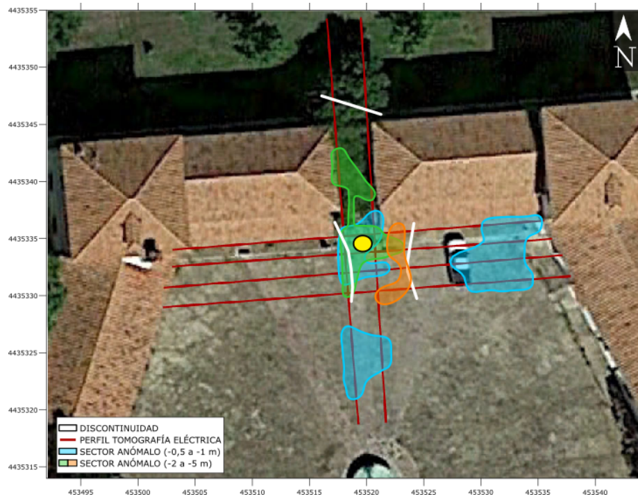
Fig. 23: Imagen satélite en la que se observan las anomalías detectadas y sobre la que se ha situado el sondeo de recuperación de testigo continuo propuesto.
