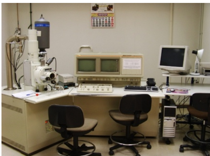
Fig 7. Microscopio electrónico de barrido (JSM-6400)
