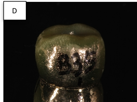
Fig 9. Recubrimiento de las coronas en oro (Sputter Coater Balzers SCD 004 (A); posicionamiento de las coronas (B); aspecto final del recubrimiento (C y D).
