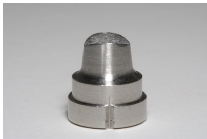
Fig 1. Probeta simulando el tallado de un premolar inferior.
