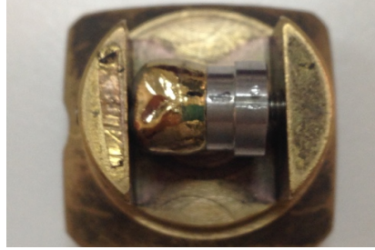
Fig 10. Dispositivo de metal utilizado para inmovilizar las coronas en la misma posición.
