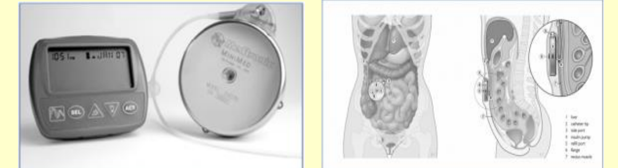
Figuras 10 y 11. Bomba parenteral programable de insulina y catéter in vivo.
