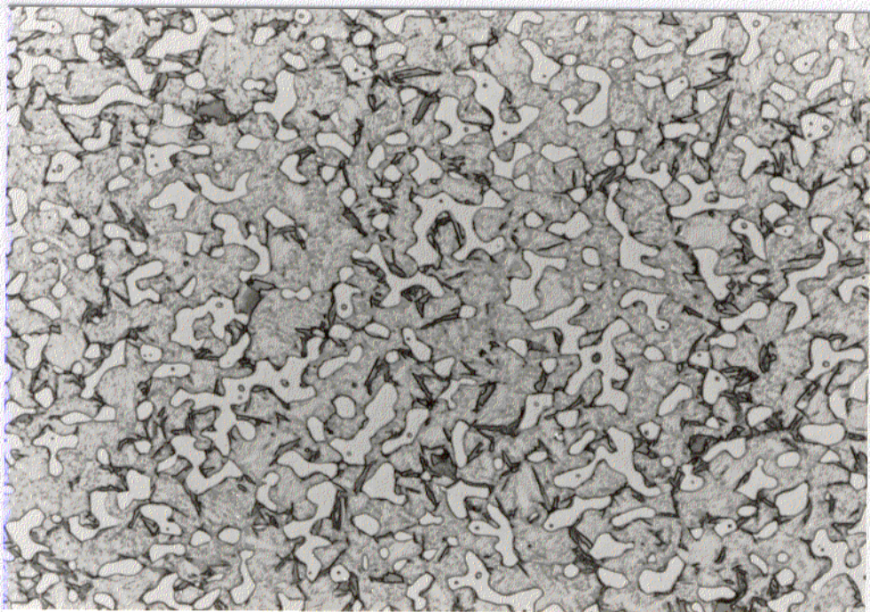
Fig. 3.23: Micrografía óptica de la microestructura después del tratamiento térmico a 1095°C/10 min/agua. Material compactado por extrusión. Reactivo de ataque: nital.
