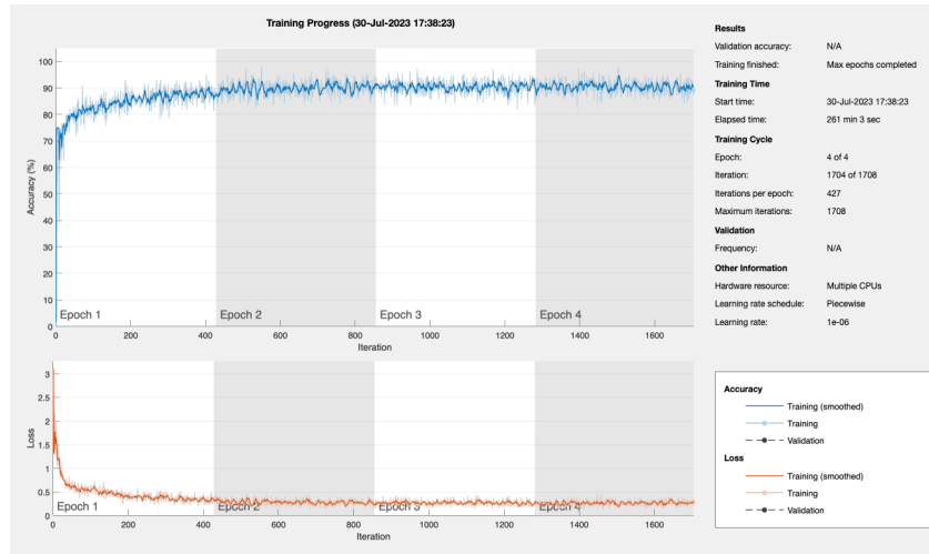
Figura 4.2: Entrenamiento del detector de objetos R-CNN utilizando la arquitectura MobileNetV2
