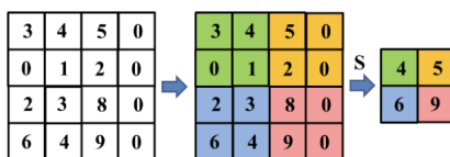
Figura 2.6: Ejemplo de agrupamiento máximo con relleno con ceros. Fuente: Aprendizaje Profundo (Pajares et al., 2021)
