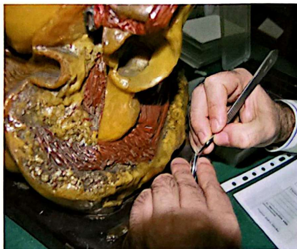
Fig. 21. Proceso de toma de muestras representativas de los materiales empleados en la manufactura inicial y en el recubrimiento actual
