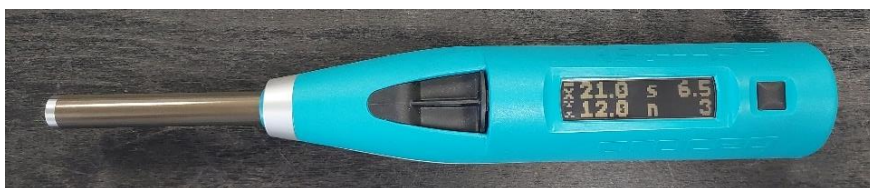
Figura 10. Martillo de Schmidt empleado. La pantalla muestra los resultados después de realizar tres impactos sobre una muestra. Indica el valor medio (21,0 R), la diferencia entre los valores máximo y mínimo (12 R) y una desviación estándar de 6,5 (S).
