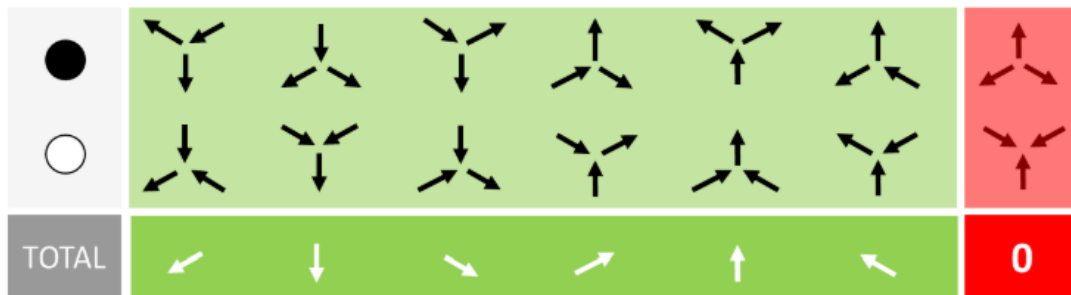
FIGURA 11: Reglas del pseudohielo de espín. Los círculos de color blanco (-1) y negro (+1) representan la orientación del campo magnético de fuga de la carga situada en el centro de un vértice. Las flechas de los momentos magnéticos indican las posibles configuraciones en cada caso. En rojo se muestran los dos estados de energía no favorables que incumplen las reglas del pseudohielo de espín. (Figura de la referencia [6]).
