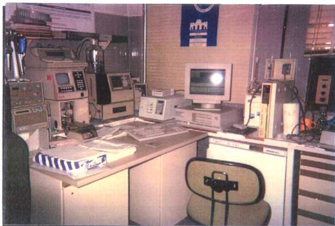
Fig.- 11. Equipo de H.P.L.C: cromatógrafo y detector de absorbanca Waters y equipo de soft-ward.
