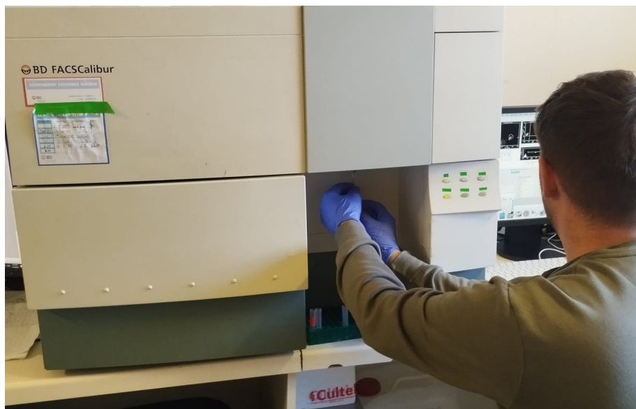
Foto 2. Citómetro de flujo usado para las prácticas: BD FACSCalibur
