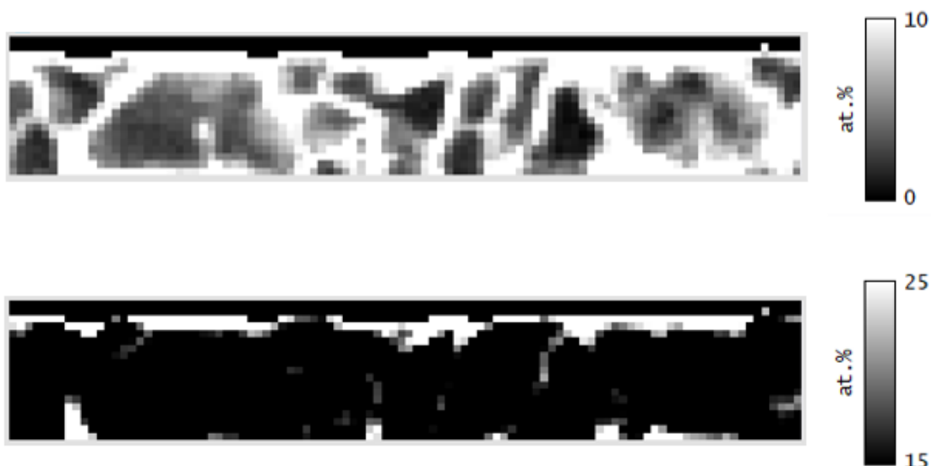
Figura 9: Mapa del porcentaje atómico de bismuto a lo largo de nuestro nanohilo. Las escalas de contraste se han ajustado manualmente o entre 0-10 % y 15-25% de Bi atómico para mostrar de manera independiente en contraste asociado con el interior de los granos y con las fronteras de grano.
