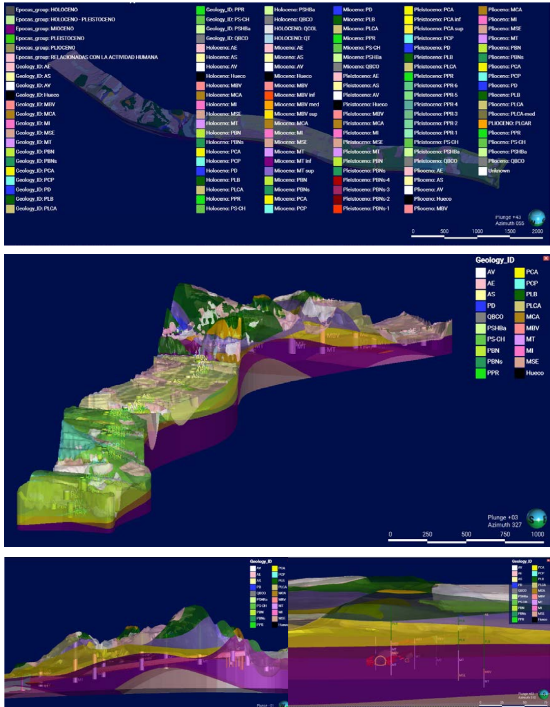
Ilustración 40 Modelo Refinado. Según la normativa BIM se trata del modelo simple que ha de ser federado
