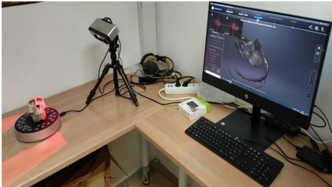
Escáner 3D scanner EinScanSP de luz estructurada con textura y escáner 3D scanner EinScanPro.
