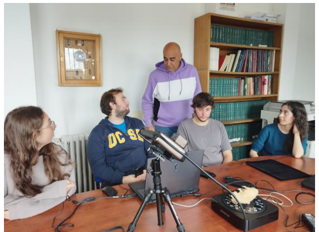
Escáner 3D scanner EinScanSP de luz estructurada con textura y escáner 3D scanner EinScanPro.
