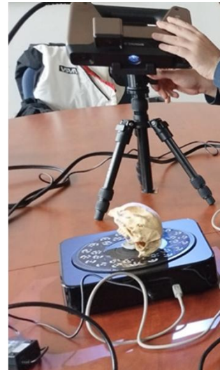
Escáner 3D scanner EinScanSP de luz estructurada con textura y escáner 3D scanner EinScanPro.
