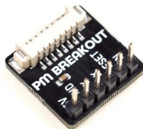
Figura 3.9 – Breakout para PMS5003
