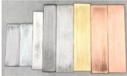
Figura 1. Kit de corrosión consistente en multímetro RS PRO IDM91E- CAT II y varios materiales metálicos (magnesio, cinc, aluminio, acero, acero inoxidable, latón y cobre).
