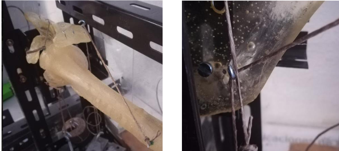
Imagen 27. Colapso de anclajes de cargas musculares
