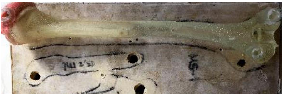
Imagen 21. En la imagen superior se muestra una réplica de vástago humeral antes de ser introducida en molde humeral. En la imagen inferior el resultado final del proceso de implantación del vástago humeral. Imagen obtenida de (113) (115).
