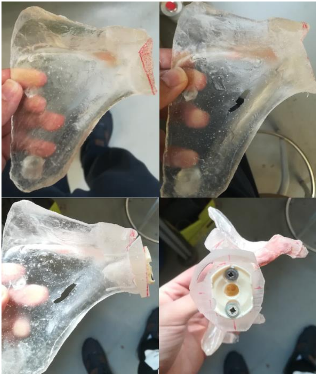
Imagen 23. Generación de defecto superior en modelo fotoelástico b) Suplementación con injerto superior e implantación de prótesis Lima SMR.
