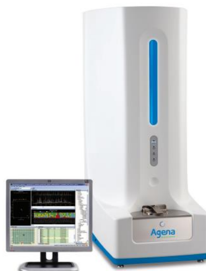
Figura 2.4. Sistema MassARRAY de Agena Bioscience que incluye el analizador, espectrómetro de masas y el software de análisis de datos, para el genotipado de SNPs en ADN genómico.
