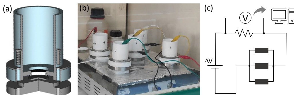
Figura 3.10 (a) Celda utilizada para la realización de procesos de anodización a temperatura ambiente. (b) Imagen del sistema en el laboratorio. (c) Circuito eléctrico del sistema de anodización múltiple.
