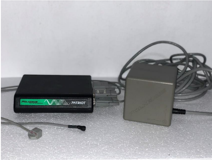
Figure 15. Sistema 6 SpaceFastrak Polhemus®. De izquierda a derecha: módulo receptor, dos sensores, módulo emisor.
