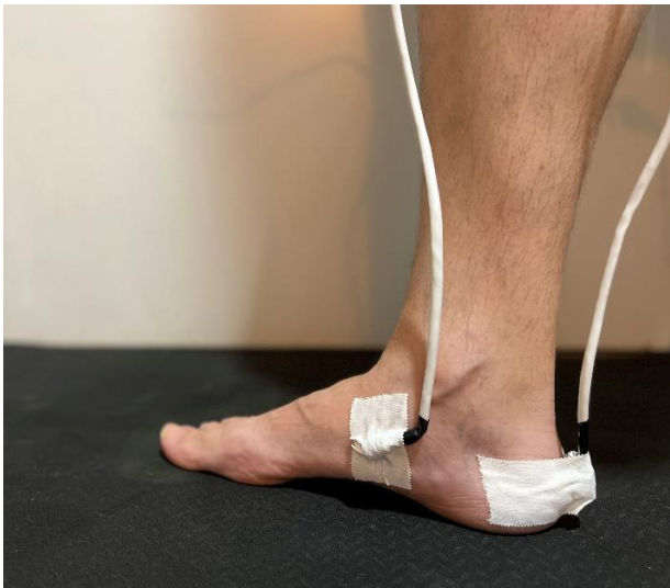
Figura 16. El sensor uno se colocó en la parte posterior del calcáneo, y el sensor dos se colocó en la parte medial del escafoides.
